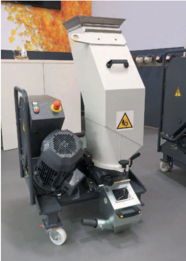
Über Verschleißschutzplatten im Trichter verfügt die Beistellmühle GRS 180 A von GETECHA. Im Zusammenspiel mit den verschleißgeschützten Hartmetall-Messern ihres Sieben-Messerrotors nimmt sie es daher auch mit abrasivem Material
