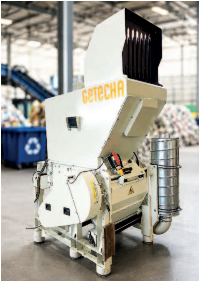
Ausgestattet mit dem Zuführsystem HHS kann die GETECHA-Schneidmühle RS 38060 voluminöse Hohlkörper ohne eine Vorzerkleinerung zu Mahlgut der gewünschten Korngröße zerkleinern (Alle Bilder: Getecha)
