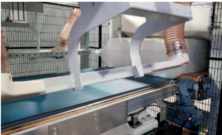
Kanisterverpackungsanlage von GETECHA: Hier werden Kanister lagenweise eingeschweißt und überstehende Folie abgeschnitten; anschließend erfolgt das Schrumpfen der Folie mit bis zu 200 °C
