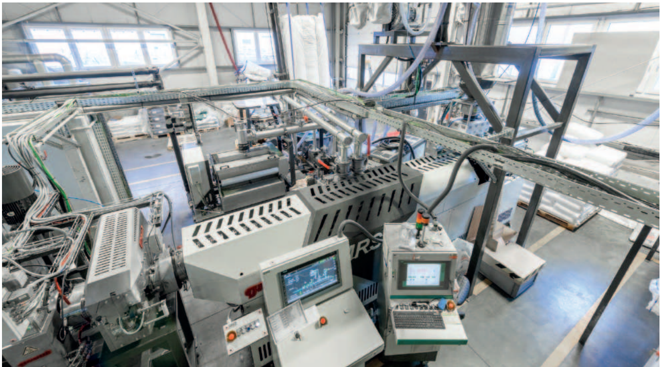
OMNI-Recyclinganlage von Gneuß, integriert in die Strapping-Bandproduktion bei UNIPACK
