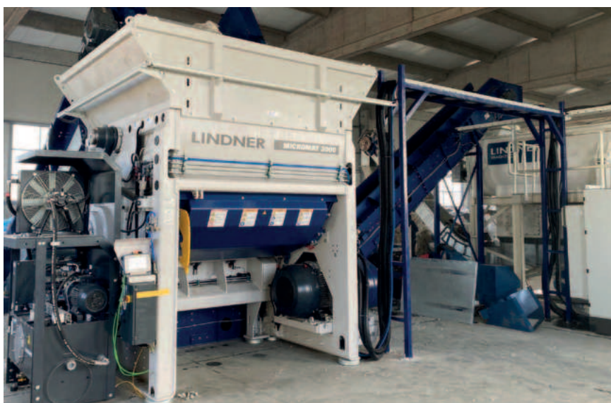
Der stationäre Einwellen-Schredder Micromat 2000 sorgt für die zuverlässige Zerkleinerung der Inputmaterialien und schafft damit die Grundlage für stabile nachgelagerte Recyclingprozesse
