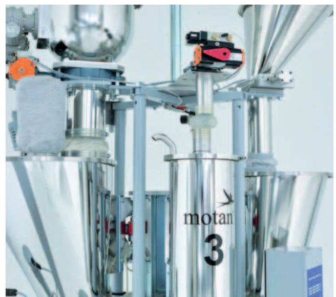
Kontinuierlich gravimetrisches Dosiersystem (loss-in-weight) mit zwei Schneckendosierern für Pulver und Granulat und einer Dosierpumpe für Flüssigkeiten. In der Mitte unten ist der zentrale Sammelbehälter zu sehen
