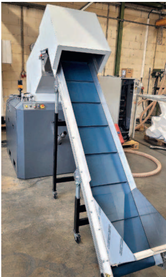
Pre-Processing: Trichtermühle von GETECHA mit Fördersystem zur automatisierten Materialzuführung
