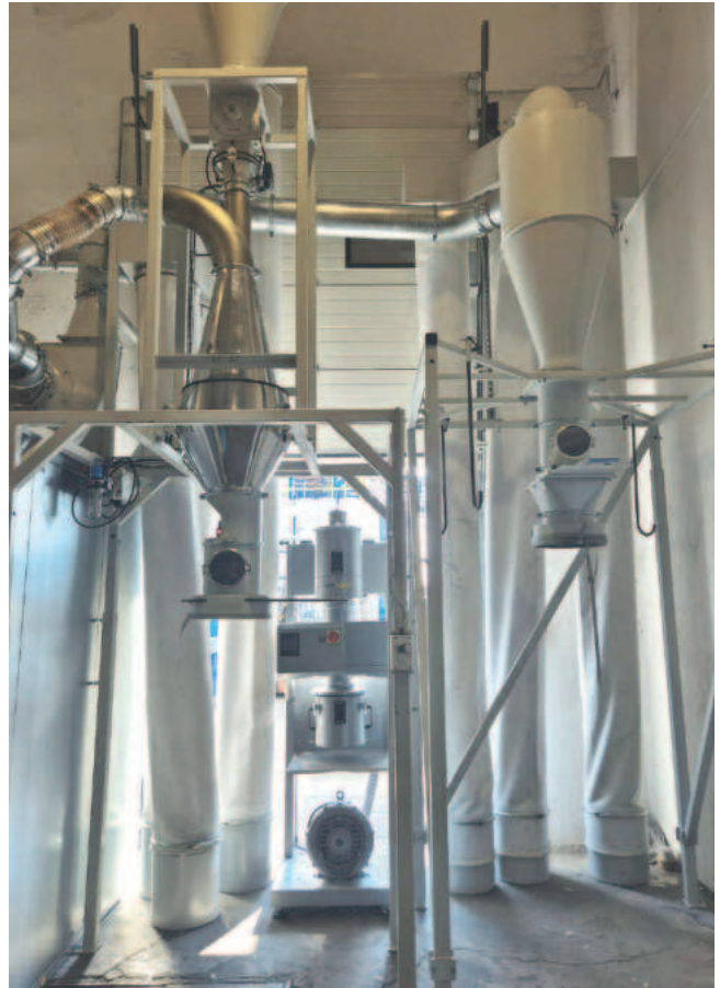
Post-Processing: Für die Materialaufbereitung nach dem Zerkleinern bietet GETECHA Komplettlösungen – unter anderem bestehend aus Absaug-, Entstaubungs- und Verpackungsanlagen
